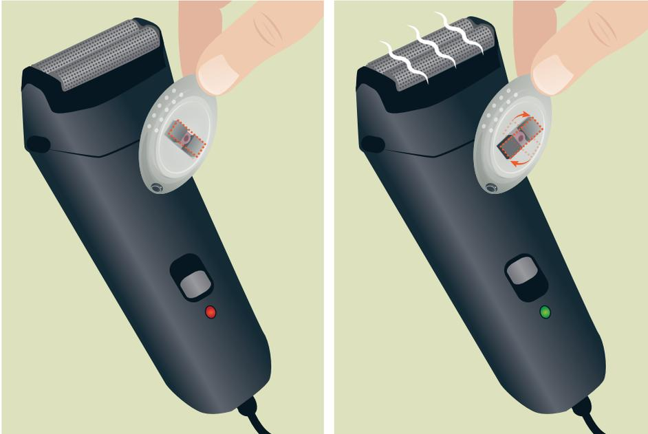
Figure 3. Exemple de cas d'interaction implant / champ électromagnétique : rotation d'une valve pour hydrocéphalie lorsqu'un rasoir fonctionne
